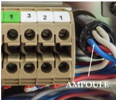
❶ Retirez le couvercle du DGPT2® et décâblez l'ampoule magnétique.
