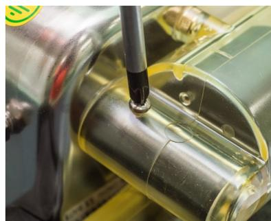
❺ Serrez la vis de blocage à l'aide d'un tournevis cruciforme jusqu'à ce que l'ampoule magnétique ne puisse plus bouger dans son logement.
