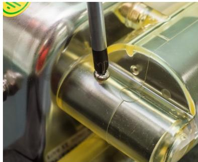
❷ Dévissez la vis de blocage à l'aide d'un tournevis cruciforme jusqu'à ce que l'ampoule soit libre.
