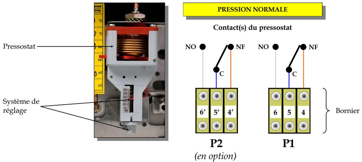
Lorsque la pression à l'intérieur de la cuve du transformateur atteint la valeur du point de consigne, le contact du pressostat bascule.
