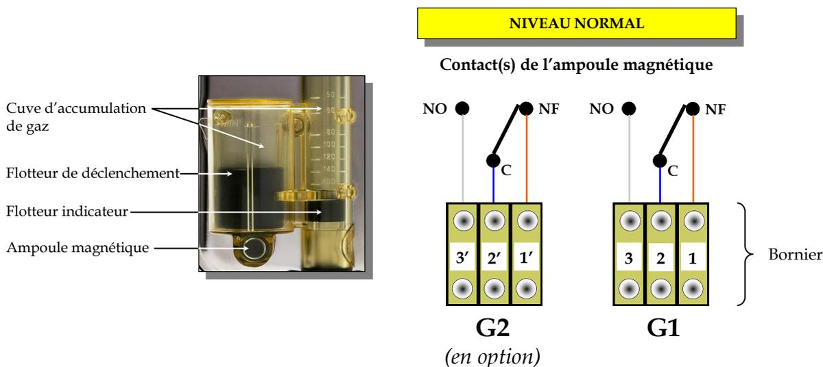
Lorsque le dégagement gazeux à l'intérieur de la cuve d'accumulation de gaz atteint une certaine valeur (fonction de la densité du diélectrique), le contact de l'ampoule magnétique bascule.
